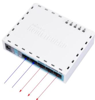
В данном случае показан вариант использования маршрутизатора MikroTik при подключении к двум провайдерам (синие стрелки) интернет. Красные стрелки обозначают внутреннюю или внутренние сети. Возможно резервирование (переключение канала/провайдера) или совместное использование обоих провайдеров. Данное устройство позволяет иметь количество подключений к провайдеру 1...4.
