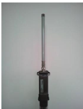
Данные устройства можно использовать с направленной или не направленной антеннами. При использовании направленных антенн можно строить радиомосты – решение вопроса «последней мили», соединения двух сетей, обеспечения доступа к удалённому оборудованию и др.
