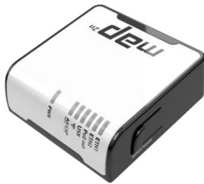
«Микро» точка доступа **mAP 2n** – данное устройство позволяет строить беспроводные сети, состоящие из одной точки доступа до сетей, содержащих десятки точек доступа. Может использоваться в качестве персонального информационного моста Wi-Fi/3G/LTE. Поддерживает работу с модемами мобильных операторов. Также может использоваться в качестве беспроводного повторителя сигнала. Они также могут быть использованы для организации беспроводного моста на небольшие расстояния.
