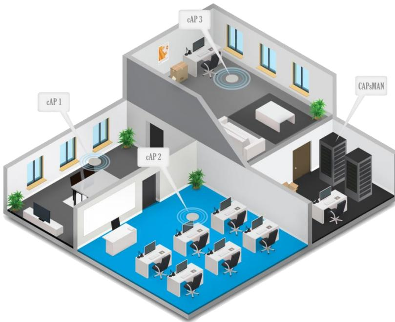
В данном случае в офисе развёрнута беспроводная сеть на основе 3-х точек доступа **сАР**, размещённых в разных помещениях и управляемых с помощью пакета CAPsMAN, установленного на маршрутизаторе. Он позволяет создать единую беспроводную сеть, управляемую одним устройством, с централизованным управлением. При необходимости, управляемых точек доступа может быть много. Параметры условий перехода от точки к точке настраиваются.
